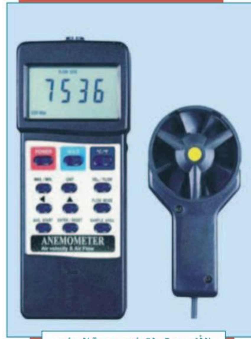
الأنيمومتر لقياس سرعة الرياح
