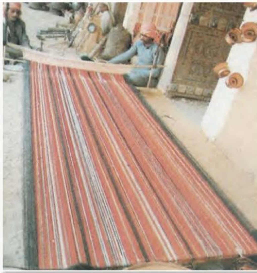
الشكل (٦٣): نول أرضي لإنتاج قطعة كبيرة.
