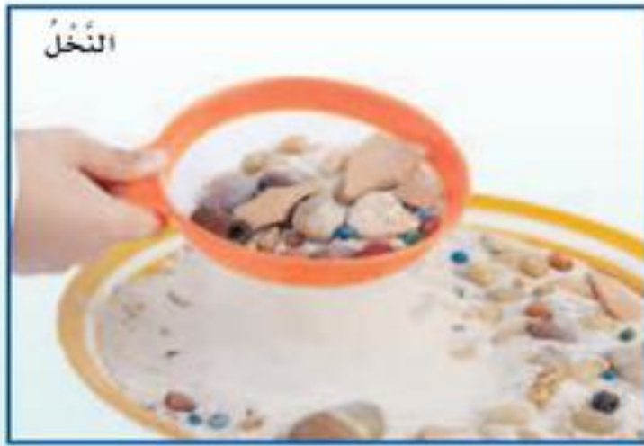
يستخدم المنخل لفصل مواد مختلفة الحجم.
