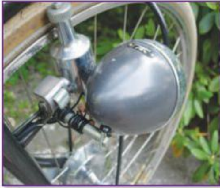
يتصل المولد الكهربائي بعجلة الدراجة
