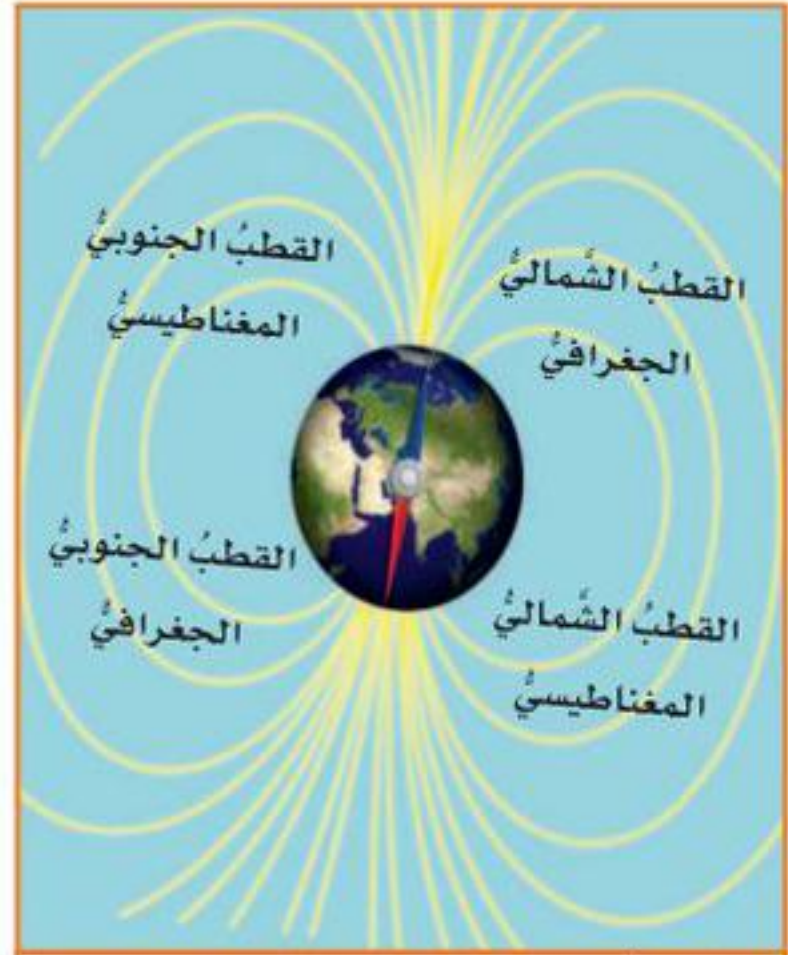
يشبه المجال المغناطيسي للأرض المجال المغناطيسي لقضيب مغناطيسي.
