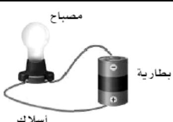
: هي مسار مغلق تتحرك فيه الشحنات الكهربائية
